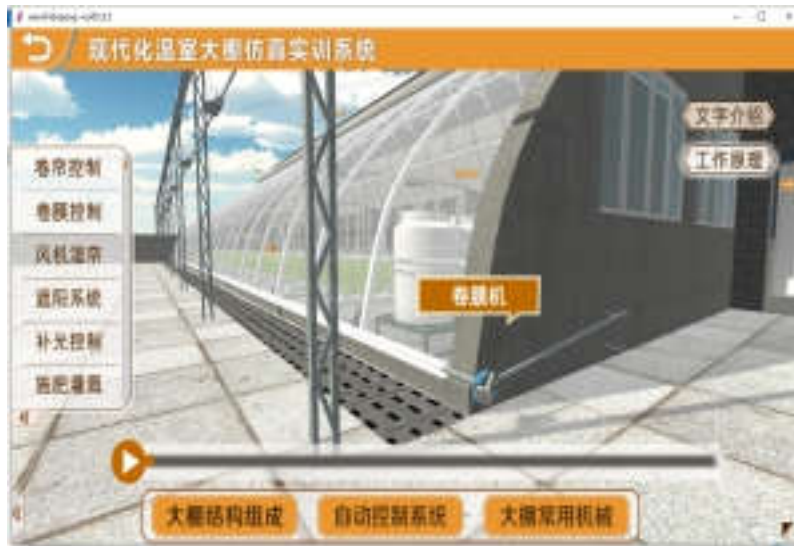
图 5 温室卷膜机工作原理展示图
